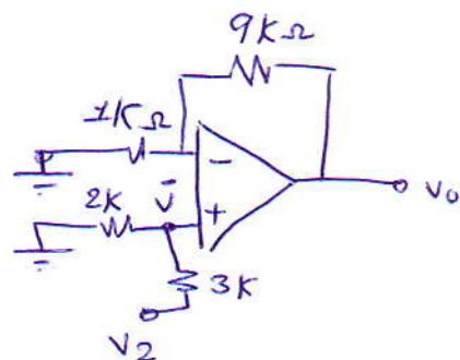
$$V_{o2} = (1 + \frac{9k}{1k}) \bar{V}$$
